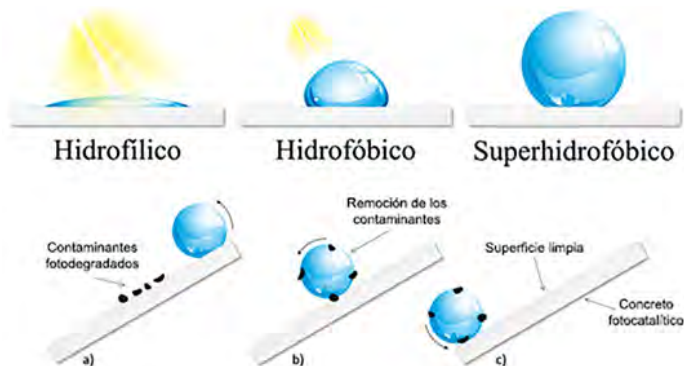
FIGURA 5. Modelo que ejemplifica el proceso de autolimpieza: a) la parte orgánica del contaminante es degradada por fotocatalisis dificultando su adherencia a la superficie; b) las gotas de agua se deslizan por la propiedad superhidrofóbica del material absorbiendo los contaminantes a su paso, y, c) los contaminantes son removidos fácilmente dejando una superficie limpia.
