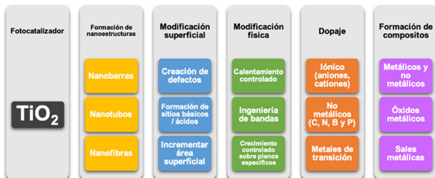
FIGURA 2. Representación de las distintas metodologías utilizadas para mejorar la eficiencia fotocatalítica del \text{TiO}_2 .
