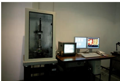
IMAGEN 3. Microscopio de fuerza atómica VEECO, SPM MultiMode.
