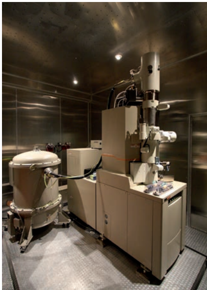
IMAGEN 6. Microscopio electrónico de transmisión de emisión de campo de ultra alta resolución JEOL, JEM-2200FS+Cs.
