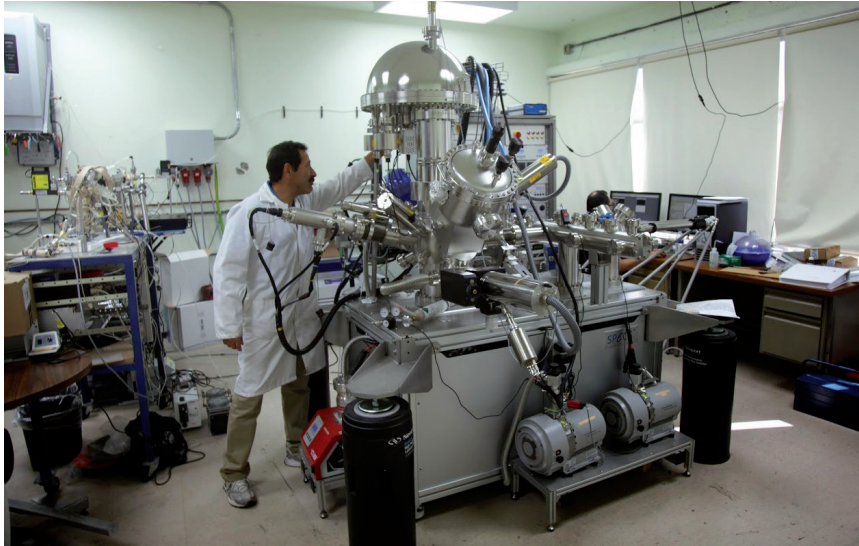
FIGURA 5. Laboratorio de XPS para el análisis químico de materiales.
