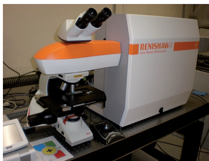
FIGURA 7. Raman (Renishaw) de última generación con sus accesorios.
