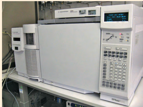
IMAGEN 3. Cromatógrafo de gases acoplado a un espectrómetro de masas con los que se analizan los gases de entrada y salida de uno de los reactores químicos del LMN del CCADET.
