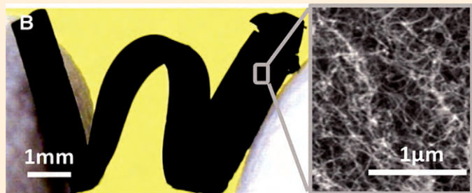
Fotografía del material con los nanotubos de carbón, junto con una micrografía SEM.
