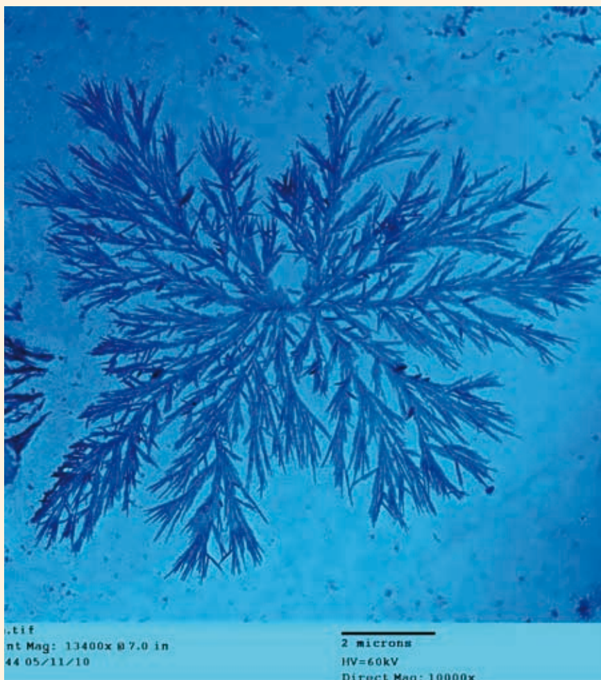
NANOFLOWER DE ÓXIDO DE TITANIO, FORMADA POR TUBOS QUE SE APRECIAN COMO RAMITAS.
