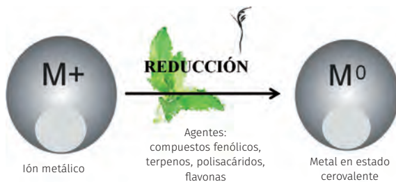
FIGURA 6. Esquema general de la biorreducción mediada por extractos de plantas.
